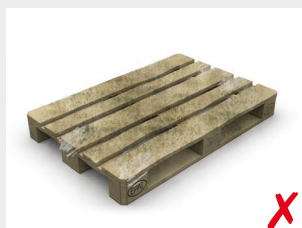
Capacité portante insuffisante (pourriture) ou contaminée (goudron, béton, etc.)
